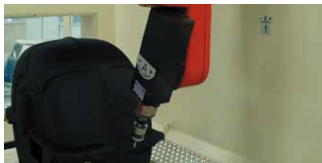
Tastatura 3D di particolare rotazionale per controllo dimensionale.
