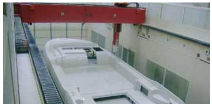
Rifilatura coperta yacht. Materiale: fibra di vetro
