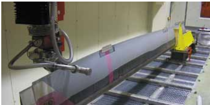
Rifilatura pale elicottero. Materiale: kevlar/titanio/fibra di carbonio
