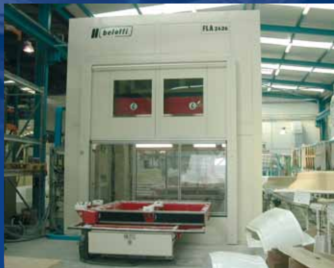
Caricatori passanti: utili nel caso di 2 aree produttive separate.
