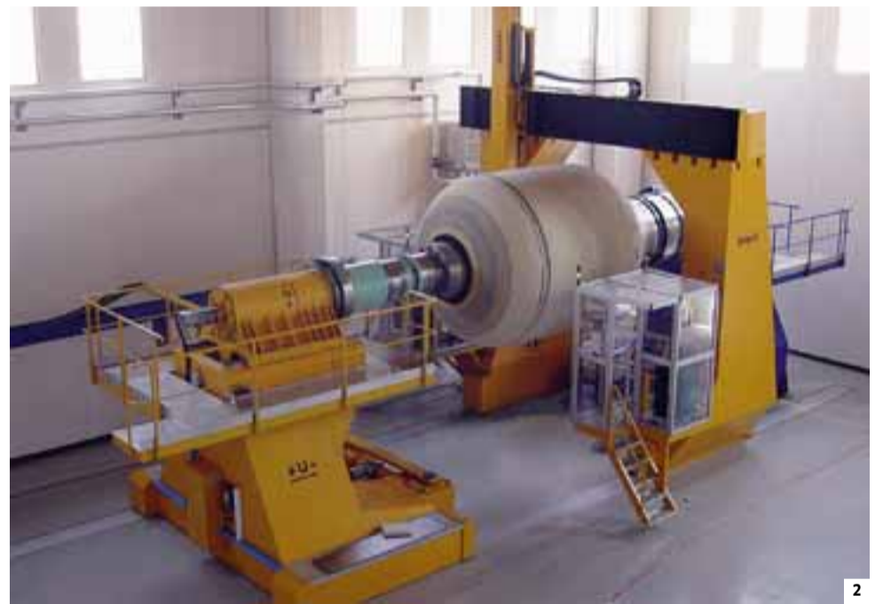
1) La rampa di lancio del vettore europeo Vega, lanciato nei giorni scorsi dalla Guyana francese 2) L'impianto messo a punto dalla Belotti per la lavorazione di tre serbatoi (al centro uno) del razzo
